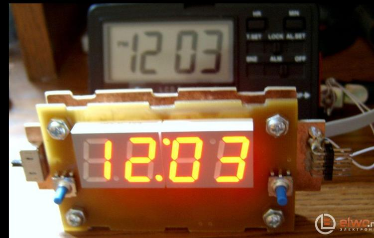
Даже без особой подстройки внутренний таймер-часы является довольно точными - не заметно никакой разницы с другими эталонными цифровыми часами.
